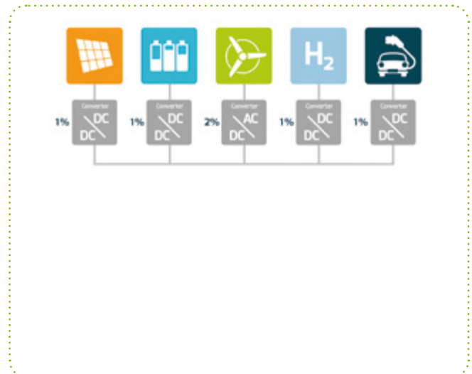
Sistema Conversor Híbrido com acoplamento DC - conexão à rede
