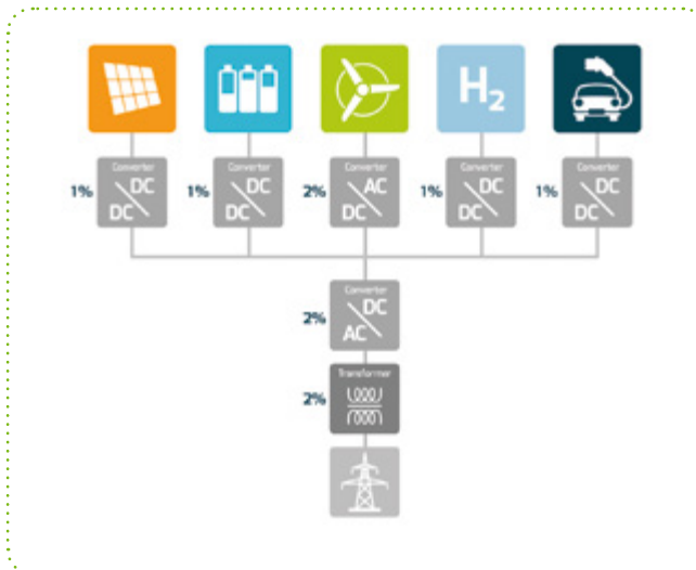
Sistema Conversor Híbrido com acoplamento DC - conexão à rede
